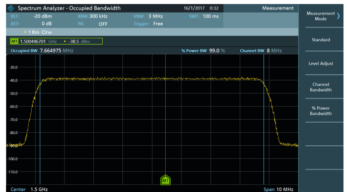
Опция R&S®FPC-K55: измерение занимаемой полосы частот.
