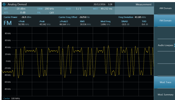
Опция R&S®FPC-K7: анализ ЧМ-модуляции.
