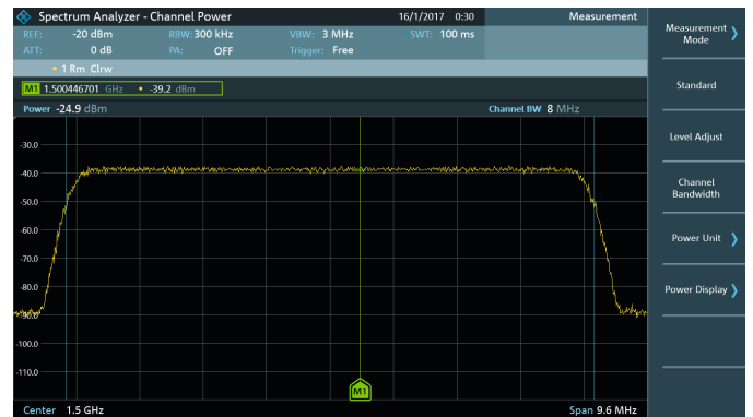
Опция R&S®FPC-K55: измерение мощности в канале.
